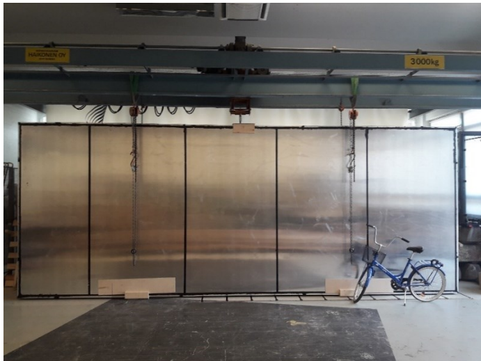
Kuva 1. Teolliseen mittakaavaan skaalattu VIS-elementti (puurunko päällystetty ohuilla alumiinilevyillä).
